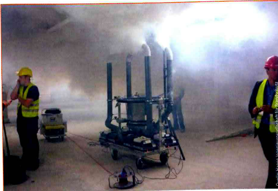
Abb. 7: Rauchversuch in der geschlossenen Garage mit der büroeigenen Versuchseinrichtung „Smoke 3“
